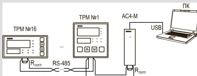
Рисунок 5.12 – Подключение приборов по сети RS-485
