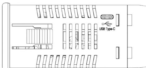
Рисунок 5.9 – Расположение разъема USB для корпуса Щ5
