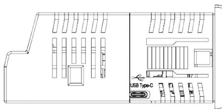
Рисунок 5.8 – Расположение разъема USB для корпуса Щ2
