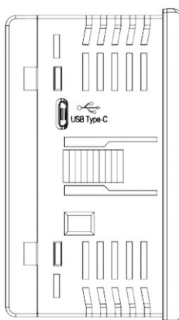
Рисунок 5.7 – Расположение разъема USB для корпуса Щ1
