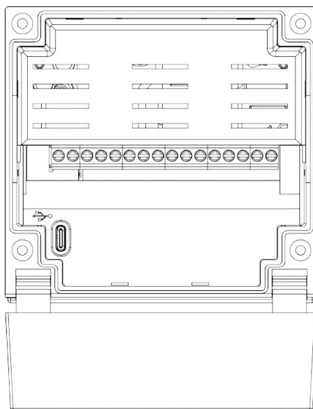
Рисунок 5.11 – Расположение разъема USB для корпуса Н
