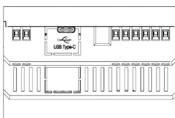
Рисунок 5.10 – Расположение разъема USB для корпуса Д
