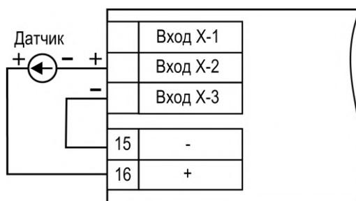
Рисунок 5.13 – Подключение токового датчика с питанием от ИП24
