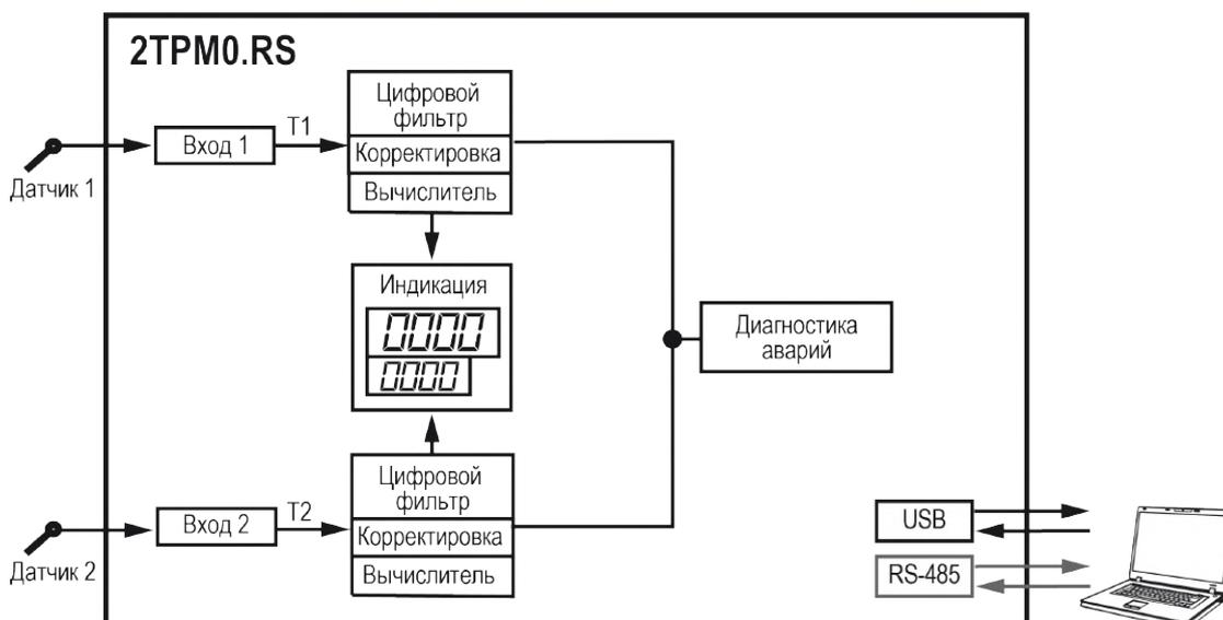
**Рисунок 6.1 – Функциональная схема**
