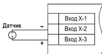
**Рисунок 5.17 – Схема подключения активного датчика с выходом в виде напряжения  $-50\dots+50$  мВ или  $0\dots1$  В**
