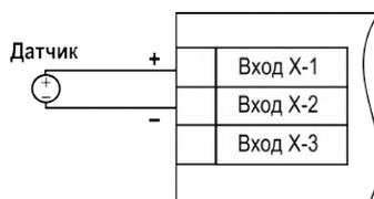
**Рисунок 5.18 – Схема подключения активного датчика с выходом в виде напряжения  $0\dots5$  В и  $0\dots10$  В**
